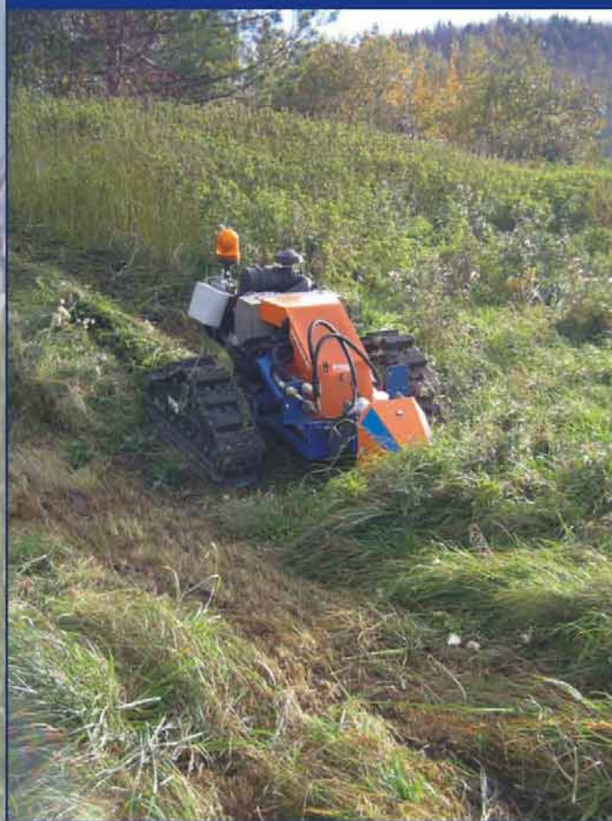
DELTRAK beim Mähen mit Doppelmesser-Mähtrieb
